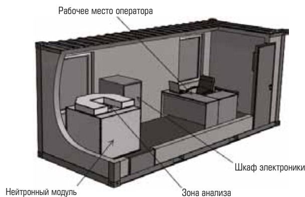
Рис. 2. Схема размещения установки АГП-Ф в транспортном контейнере
