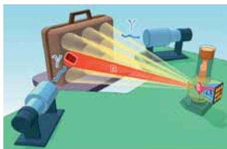
Рис. 1. Общая схема метода меченых нейтронов
