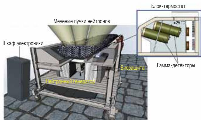
Рис. 4. Общий вид потокового анализатора АГП-К
