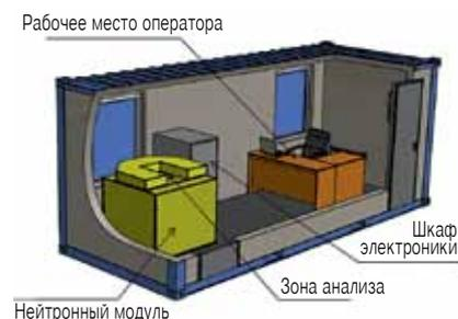
Рис. 3. Схема размещения стационарного анализатора в контейнере
